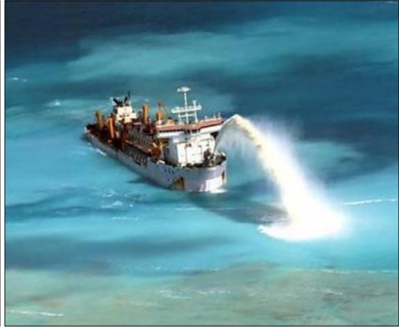
图 16：耙吸式挖泥船（附件 792）
