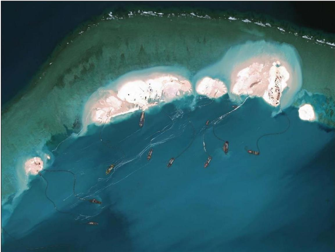
图 17：正在美济礁作业的挖泥船（附件 792）
