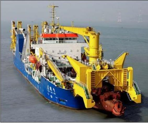
图 15：天鲸号绞吸式挖泥船（附件 858）
